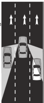
El diagrama adjunto muestra los “puntos ciegos” alrededor de su vehículo, en los que no puede ver con los espejos de su vehículo.
