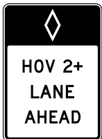
Imagen 2.6: Señal de carril reservado
