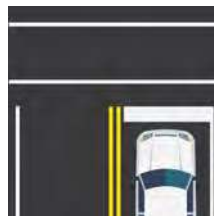
Línea Blanca de Pare y Paso Peatonal
