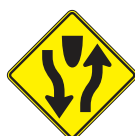
Comienzo de Carretera Dividida
